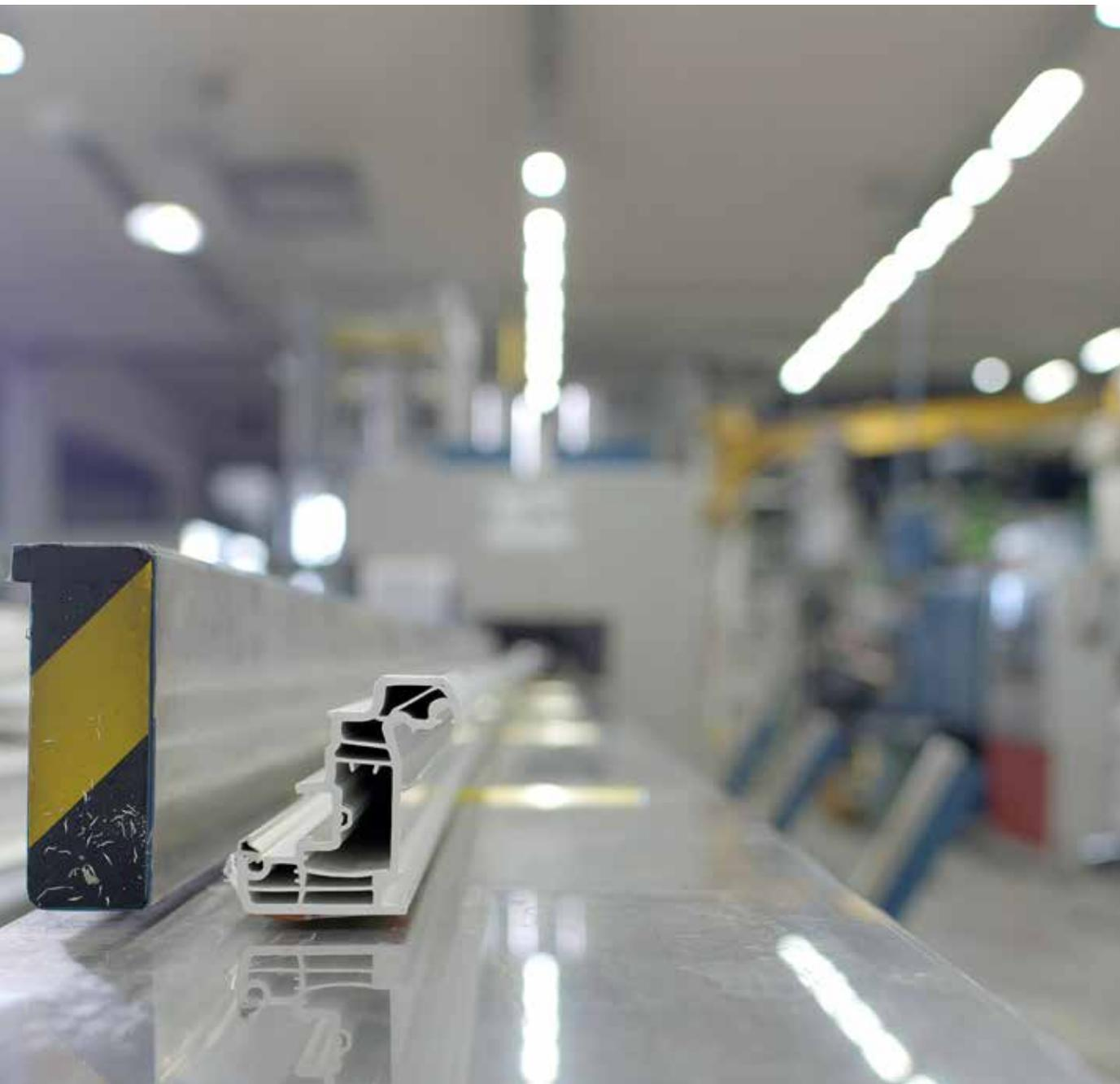
Di base, funziona come un torchio per pasta: estrusione di un profilo in PVC nel nostro stabilimento di Cortaccia in Alto Adige.
