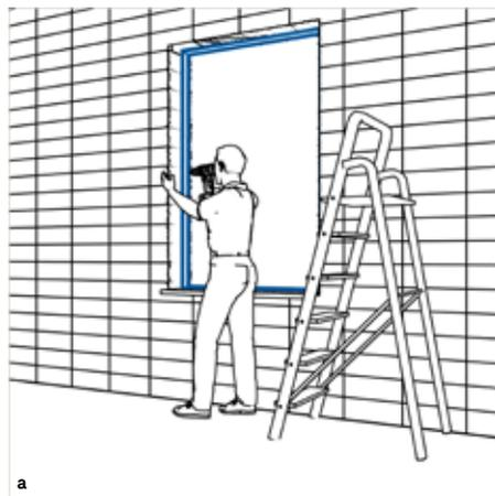
Intonachiamo il controtelaio FIN-Fix nella muratura grezza. Oltre a creare un elemento di raccordo standardizzato per la finestra, il controtelaio consente di integrare dotazioni per avvolgibili, componenti elettrici, aeratori o altro già in fabbrica.
