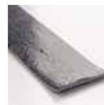
Il PVC di colore scuro si scalda rapidamente e diventa malleabile a partire da meno di 80 °C, tendendo a deformarsi.
